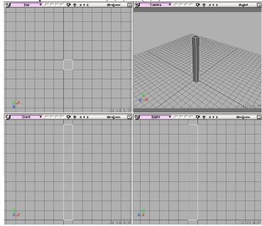
c. un dossier, de taille (1, 10, 10), reposant sur le plan XZ, appuyé sur le plan YZ.
